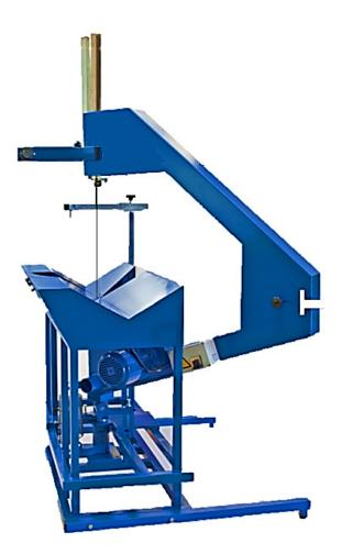
La scie à ruban est adaptée à la fabrication d'échantillons pour des essais de fluage sous pression interne, pour des essais à chute de billes, pour un stockage au chaud. Il est possible de sectionner des tubes en PE, PP et PVC jusqu'à un diamètre de 450 mm.
