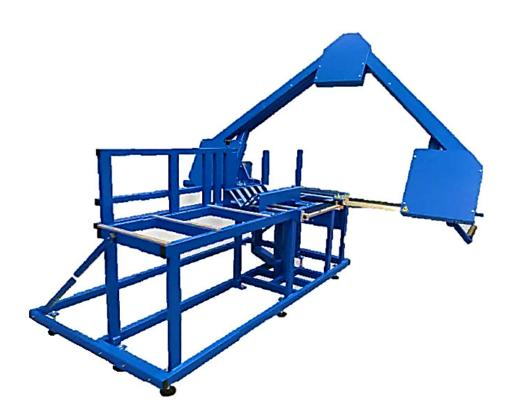
La scie à ruban est adaptée à la fabrication d'échantillons pour des essais de fluage sous pression interne, pour des essais à chute de billes, pour un stockage au chaud. Il est possible de sectionner des tubes en PE, PP et PVC jusqu'à un diamètre de 630 mm.
